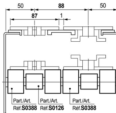
Les transporteurs à plusieurs voies, avec chaînes de largeur 82,5mm / pas 88mm, peuvent être transformés et adaptés pour le transport des bouteilles en PET avec fond pétaloïde ou pour des autres produits instables. En remplaçant les chaînes (largeur 82,5mm avec celles de 87mm) et les guides de glissement, le système de conversion permet la réduction de jeu (1mm à la place de 5,5mm) et maintient inchangée la structure de transporteur (pas 88mm).
